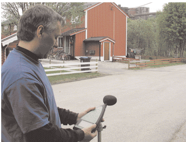
Det utføres støymålinger i boligområdene nærmest industriparken. Det nye skrapkonseptet har redusert støyen fra bedriften.
