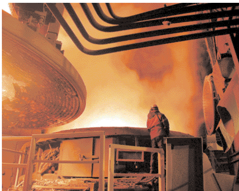
Årlig smeltes 780 000 tonn skrap i Stålverket. Utstøpt billets leveres til eget valseverk og til eksterne kunder.
