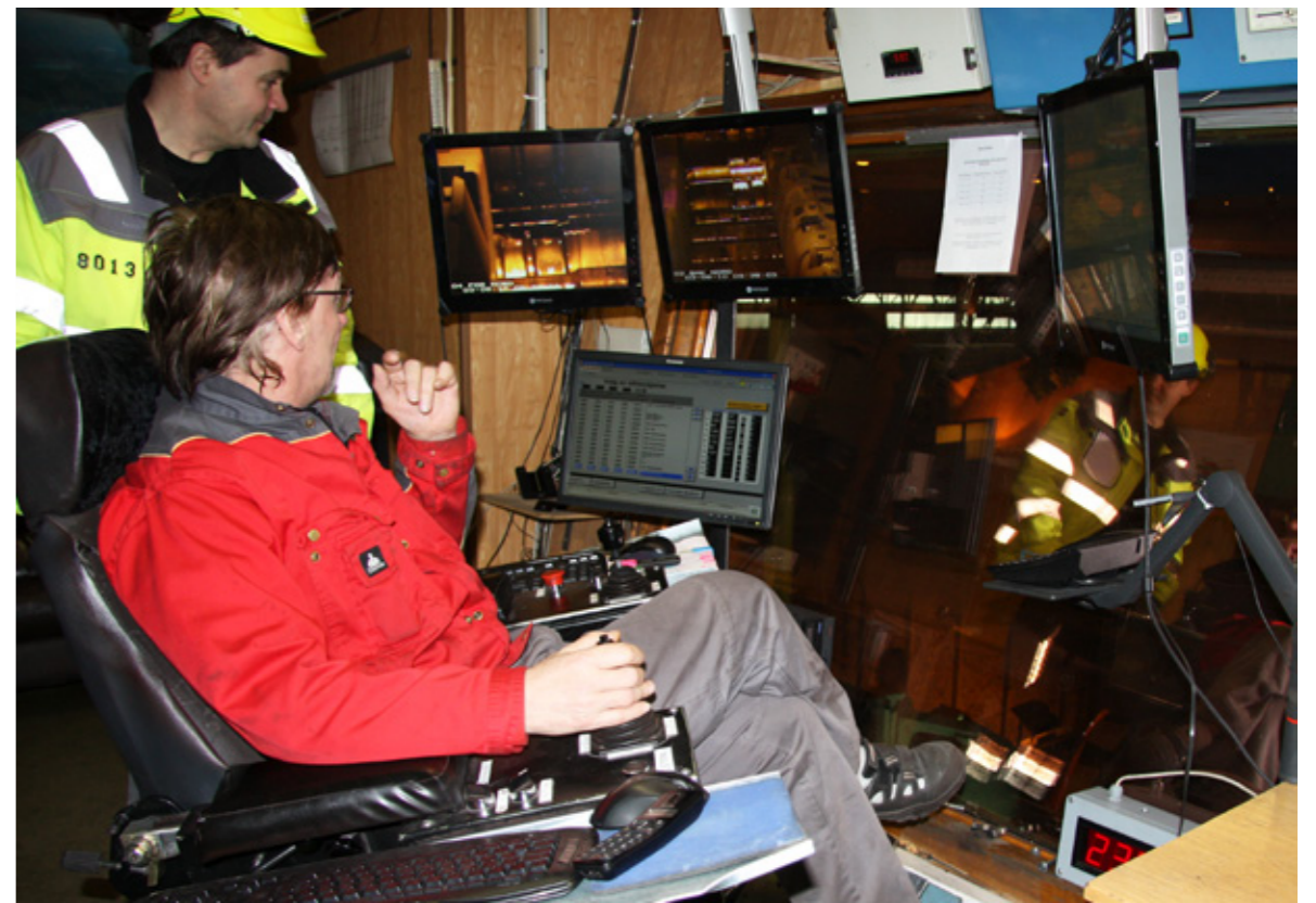
Operator Brynjar Bratland og servicetekniker Alf Kristian Pedersen studerer toleranseverdiene ved valsing av emner for vindmølleflenser.
