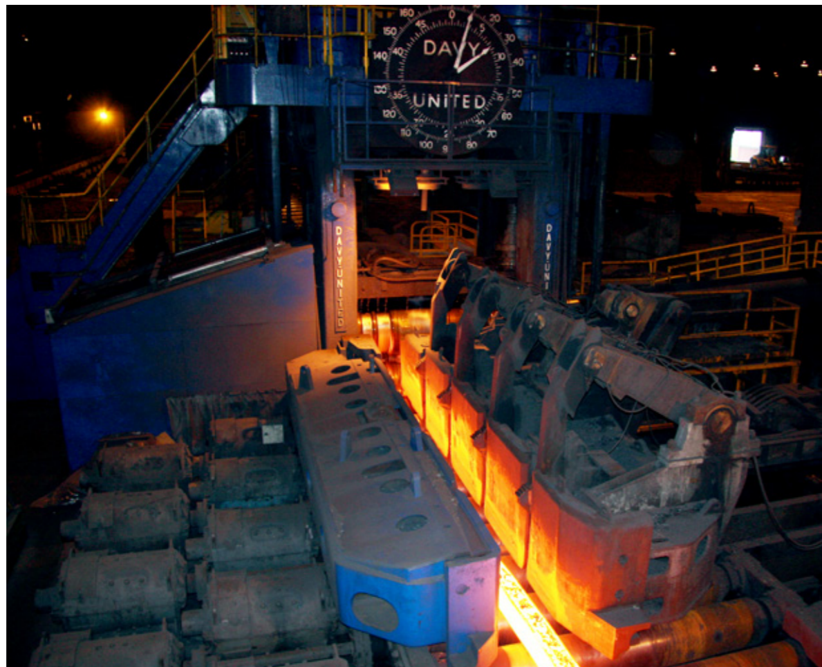
Et emne til vindmølleflenser går gjennom blokkvalsen. Produktet har meget høy kvalitet og er kjent i markedet for sine skarpe kanter og gode toleranseverdier. Ruukki Profiler har hatt en tredjedel av verdensmarkedet for dette produktet.
