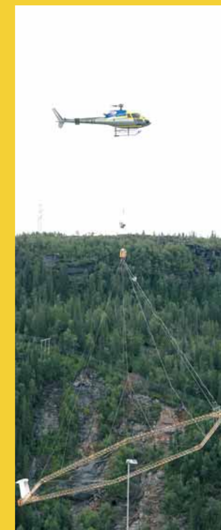
MoMin AS bruker helikopter med en coil som har en slynge av kabler som sender em-bølger i undergrunnen, for å lokalisere forekomster av metaller.
