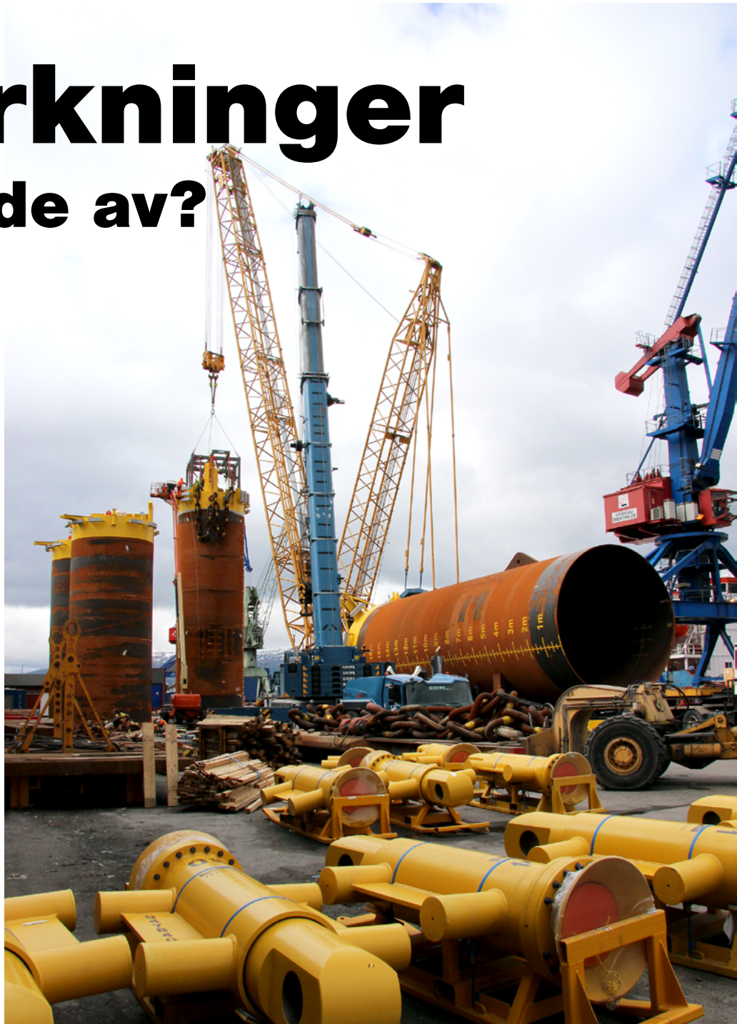
Fra utskipningen av sugeankrene til Aasta Hansteen plattformen fra Rana Industriterminal AS i juni 2015. Disse ble produsert ved Momek Fabrication AS.
