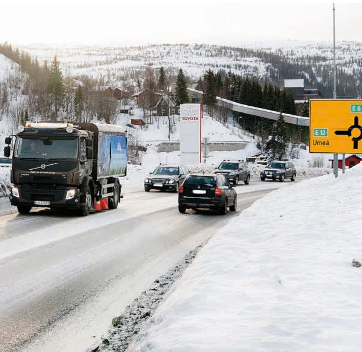
Etter investeringen i ny feiebil har Anleggs-Service og Reidar Lillejord kunnet feie opp tonnevis med støv på kalde dager. Dette er støv som man tidligere måtte la ligge ettersom tradisjonelle feiebler ikke kan benyttes i streng kulde.
