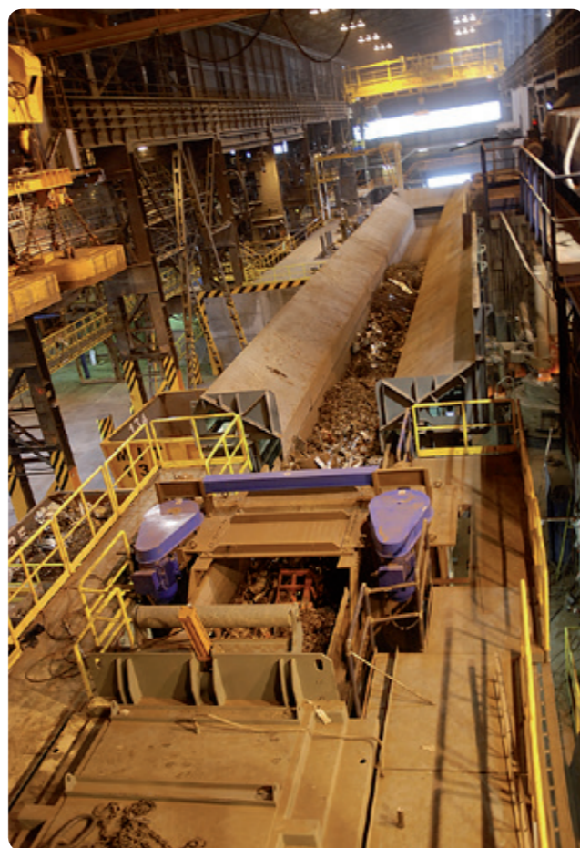
Innmatning av skrap på ovnen skjer kontinuerlig.
