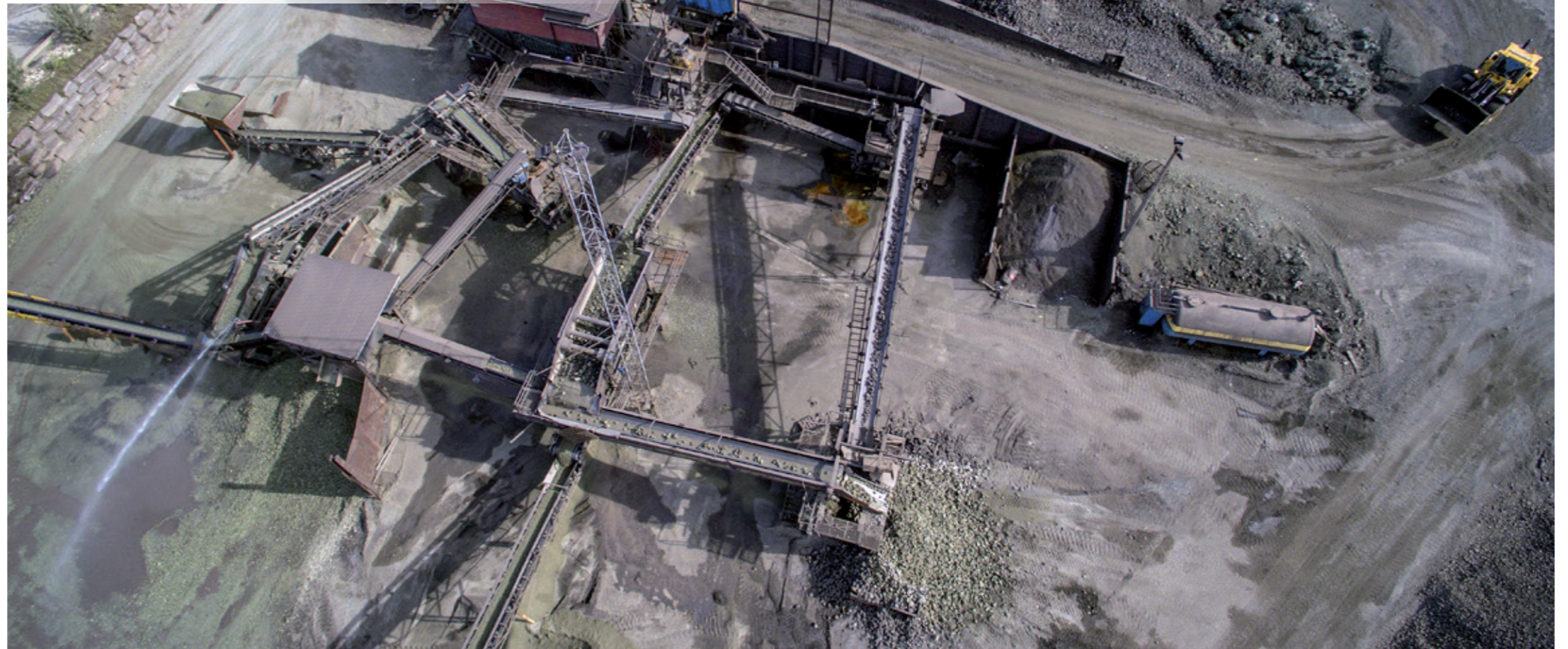
Ved Øijord og Aanes Entreprenørforretning AS får det grønne slagget fra Glencore Manganese Norway AS nytt liv, og brukes for eksempel som fyllmasse i parkeringsplasser eller ved veitbygging.
