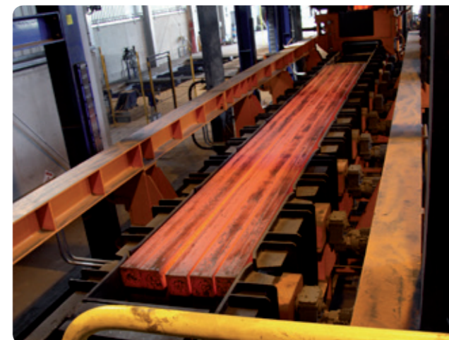
Stålemner på over 800 grader er tatt ut av termoboksen og er i ferd med å settes inn i emneovnen i Valseverket. Hot Charging-anlegget vil redusere energiforbruket med opp til 30 GWh i året.
