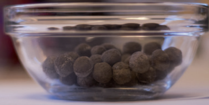
Reisen fra rensestøv til ren sink er lang. De første stegene gjøres ved Miljøteknikk Terrateam, som omdanner rensestøvet til små brune pellets.
