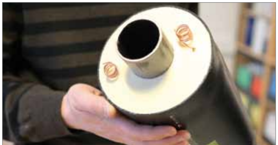
Tversnitt av et fjernvarmerør; stålrør innerst, deretter isolasjon, og ei beskyttende plastkappe ytterst. Kobbertrådene er en del av fuktovervåkinga i fjernvarmerørene.
