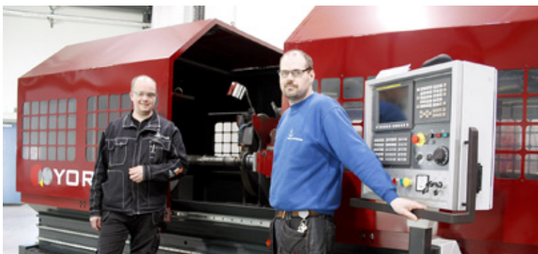
Den nye slipemaskinen kan utføre maskinering på emner på hele 16 meter, med diameter inntil 300 millimeter.
