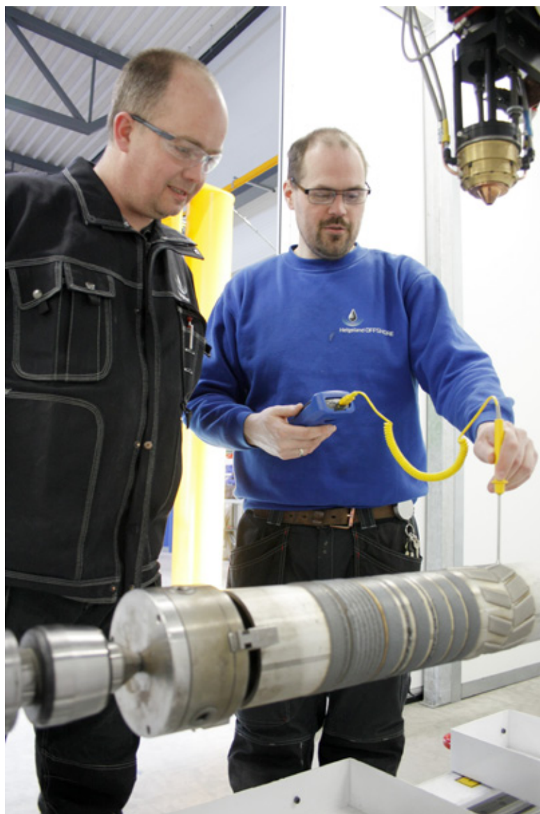
- Vi følger godt opp planen for første driftsår, og ser gode resultater både på kvaliteten i arbeidet og i markedsføringen, sier Tor Vidar Skar og Tor Johan Magnussen Helgelands Offshore AS. Her måler Tor Johan resultatet av påleggssveisen.
