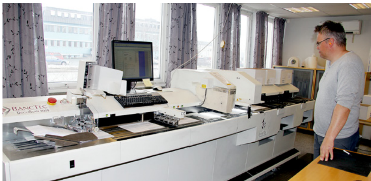
Denne skanneren kan skanne 125 ark i minuttet. Det vil si 7500 stykker i timen. Dette er en industriskanner og er unik i Rana. Teoretisk kan den skanne 9000 ark i timen, men oppløsning og type ark som skal gå gjennom skanneren gjør at Itella har valgt å redusere hastigheten.
