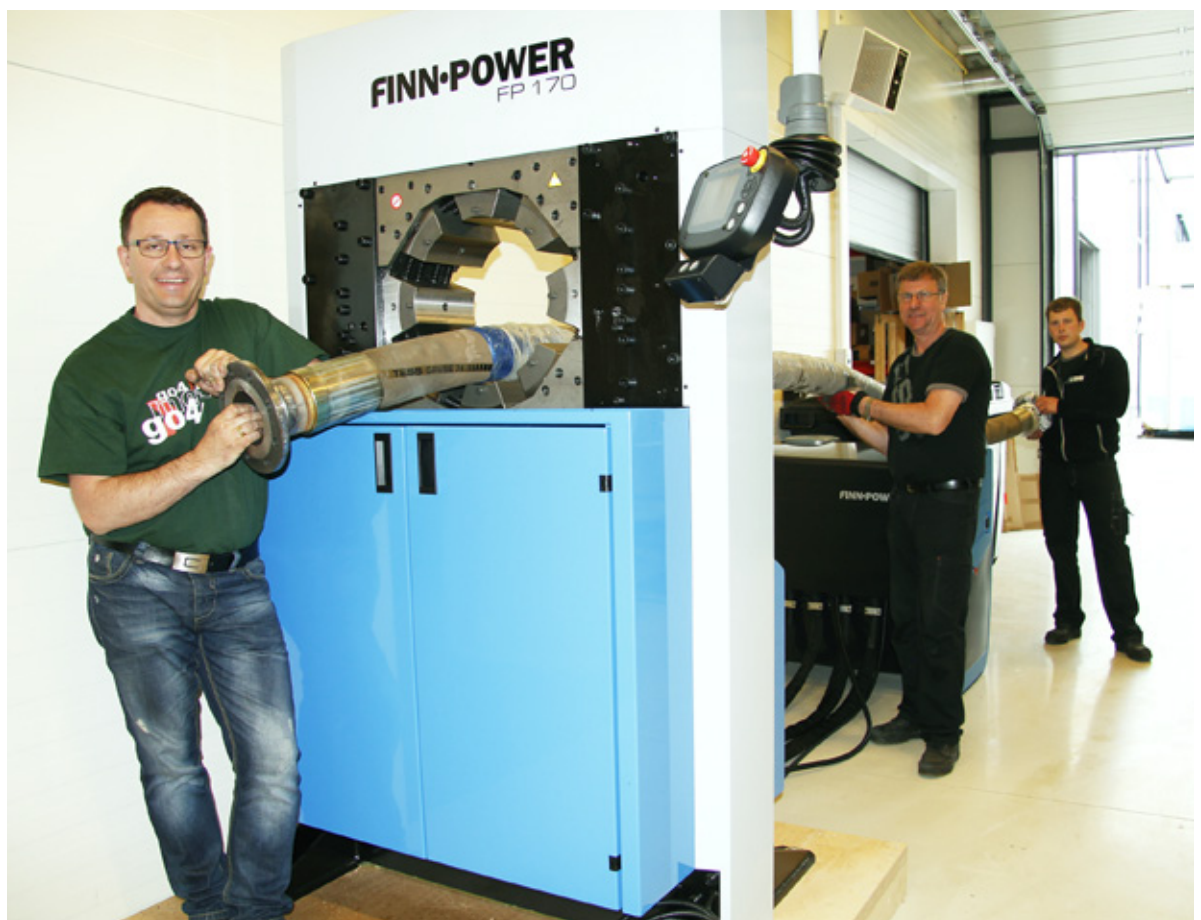
- Denne typen slangepresse er hovedsakelig rettet mot offshorekunder og brukes ofte til bunkringslanger mellom supplybåter og faste innstallasjoner ute i havet, sier Steinar Finneide i TESS Rana AS. Her sammen med Roy Olsen og Knut Haugan.
