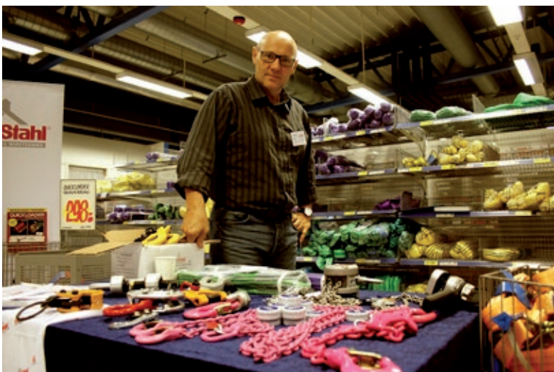
Fine farger på utstyret indikerer sterkere bruddstyrke. Her viser Hogne Øverbø løfteutstyr fra leverandøren Carl Stahl.
