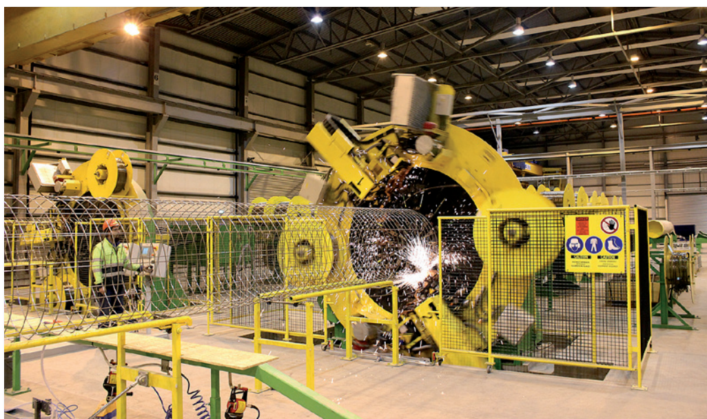
Maskinen for produksjon av armeringsnett for coating av rørene ved Wasco Coating Norway AS er testet og klar for produksjonsstart i april.
