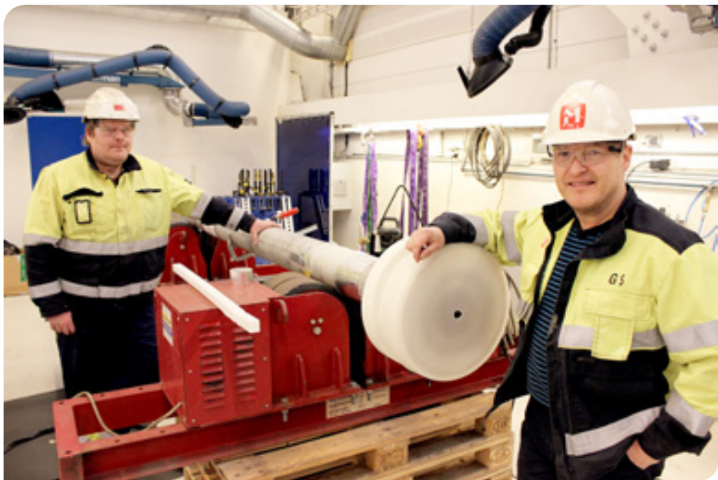
- Dette er en HUB-connection piece, et rør som skal brukes for væsker som det stilles store krav til, blant annet på grunn av trykk og antikorrosjon.
