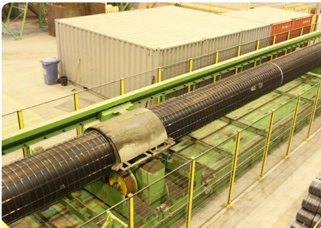
Det meste av produksjonsanlegget går på full automatikk. Her går ferdig armerte rør på automatiske vogner inn for heavy coat, der betongen «skyttes» fast på rørende mens de roterer.
