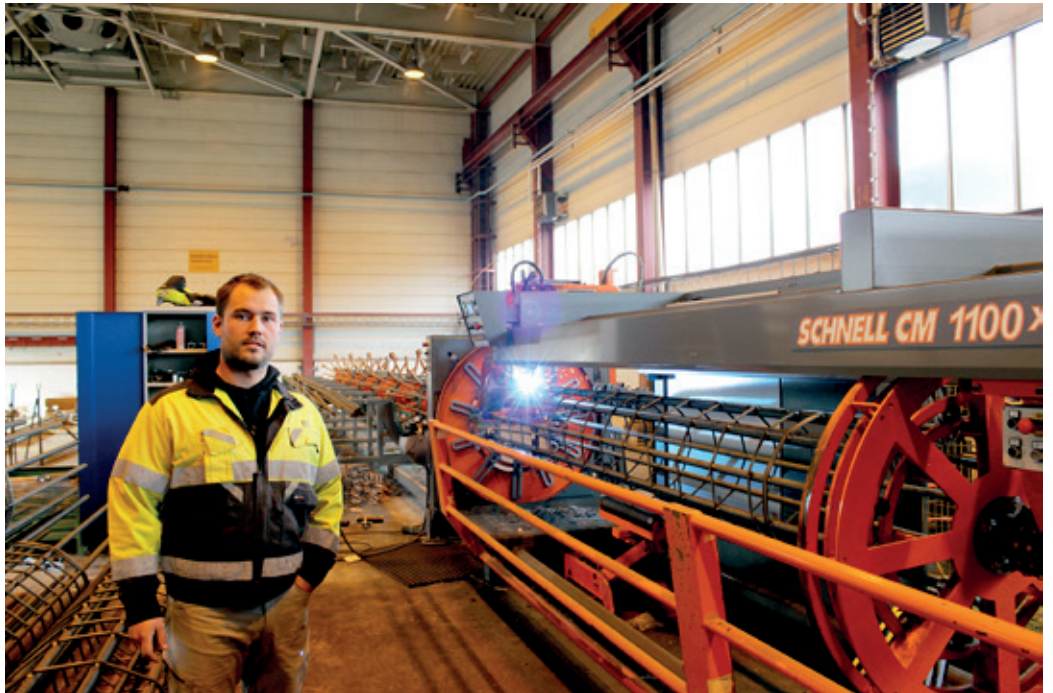
Marius Reinsnes ved IMO Sveiseindustri AS foran den nye sveisemaskinen for søylearmering. Ordren som her produseres er armeringssøyler til kaipeler for ny kai for Kleven verft i Ulsteinvik.
