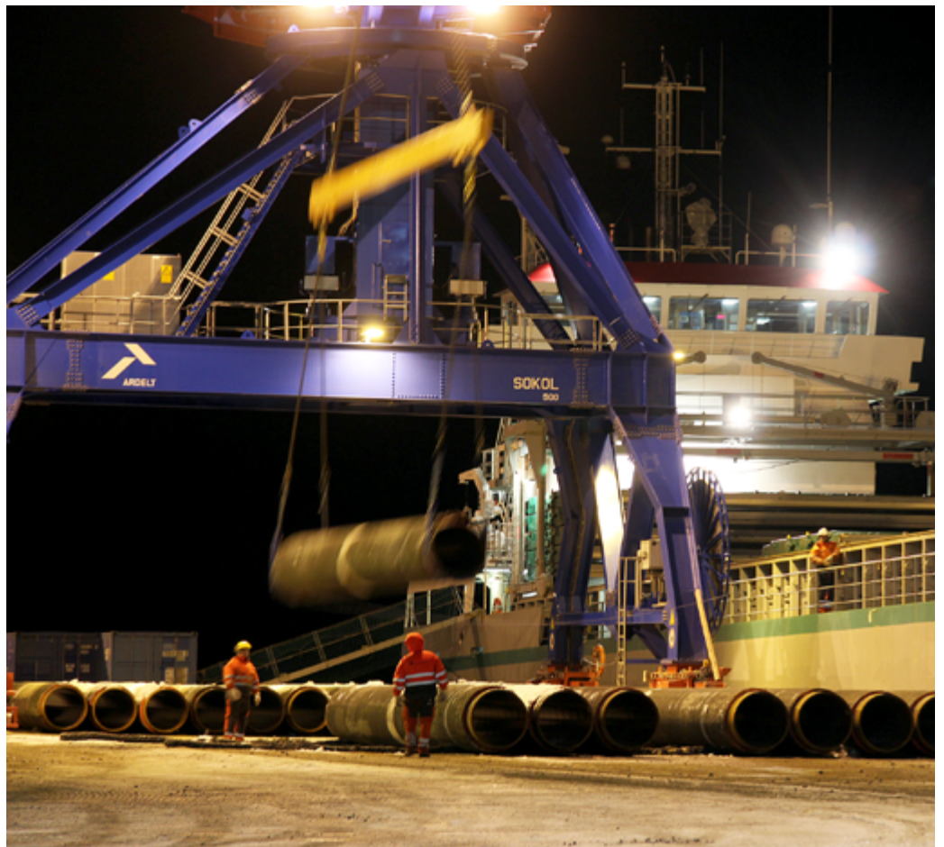
Natt til tirsdag 25. februar startet lasting av de i denne omgang siste av de ferdig coatede rørene for Wasco Coatings Norway AS som skal for forhåndslagres på Averøya ved Kristiansund.
