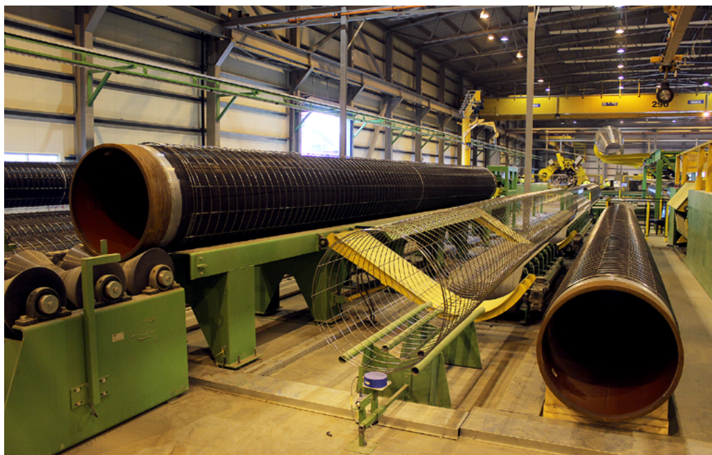
Den meget positive mottakelsen fra industrimiljøene i Mo i Rana gjorde at vi inngikk en intensjonsavtale for etablering her. Dette ga oss mulighet til å gi et godt tilbud på Polarled-prosjektet, sier Colin Mather. Bildet viser påsetting av armering i produksjonsanlegget.
