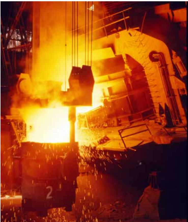
Tapping av en av tre elektrostålovn over i ausen i 1981. De tre eldre, små elektrostålovnene ble planlagt utskiftet med oppbygging av én, ny elektrostålovn etter at strengstøpeanlegget hadde kommet i drift.
