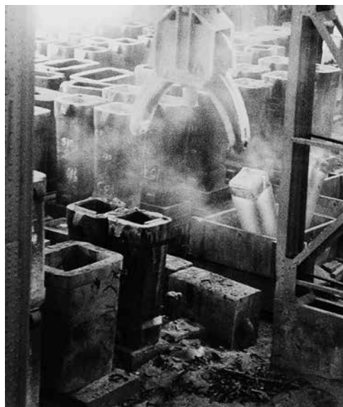
Stripperhallen. Stålemlene tas ut av kokillene og klargjøres for valsing.
